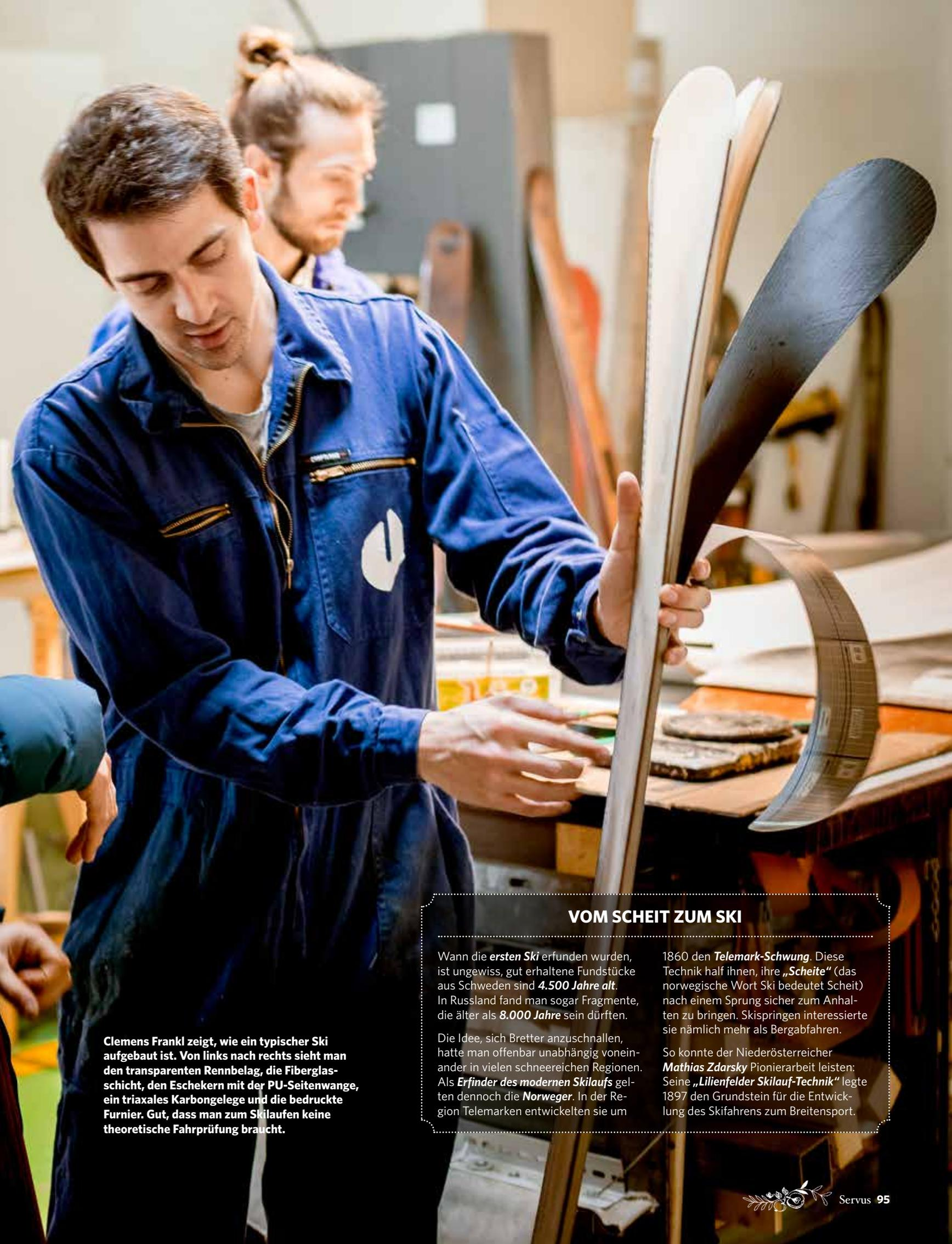
**Clemens Frankl zeigt, wie ein typischer Ski aufgebaut ist. Von links nach rechts sieht man den transparenten Rennbelag, die Fiberglaskompositenschicht, den Eschekern mit der PU-Seitenwange, ein triaxiales Karbongelege und die bedruckte Furnier. Gut, dass man zum Skilaufen keine theoretische Fahrprüfung braucht.**
